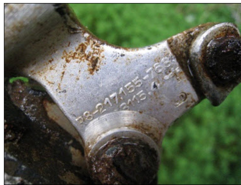
Číslice 217 vyražená na nalezených troskách je zatím jediným přímým dokladem, že zřícené letadlo bylo skutečně typu Dornier Do 217.
